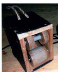
**古柳** こうして腰に車の紐をしっかりと結んで固定して、さらに人形の両足の踵の「かかり」を足指に挟み込んで動かすので両足をダイナミックに動かせます。四代目がボールベアリングを導入したのでさらに前後左右、ぐるりとスムーズな動作が行えるようになっています。舞台上で立体的な動きができるのが車人形の特徴ですね。
